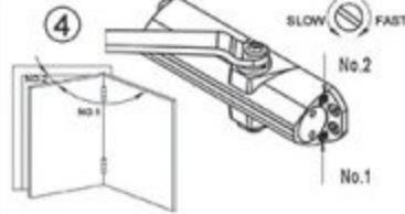
Regolare la velocità di chiusura tramite la vite di regolazione 1.
